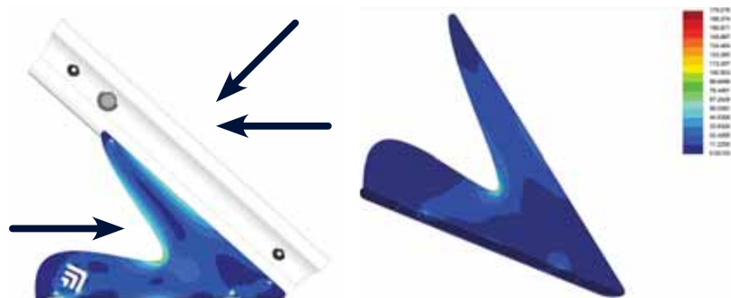
SIMULAZIONE CON ANALISI FEM DEL CARICO DEL VENTO E DELLA NEVE
